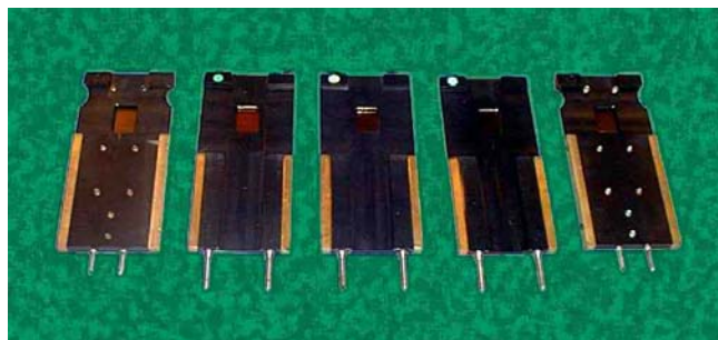
Рис. 3. Общий вид кассет магнитооптических кристаллов
