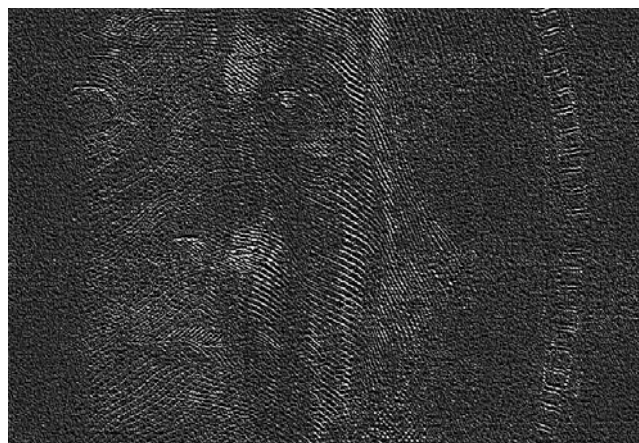
Магнитооптическая визуализация того же фрагмента. Программная обработка изображения: негативное представление и 3D «выдавливание» делают магнитные штрихи более наглядными.
