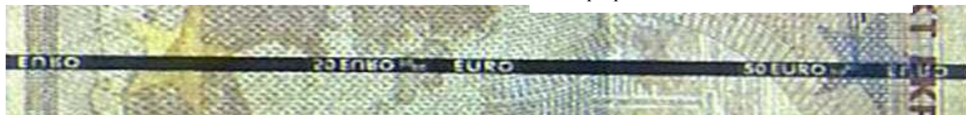
Фрагмент денежной купюры 50 EURO в области металлической защитной полосы. Изображение в проходящем свете позволяет наблюдать микротекст защитной полосы.
