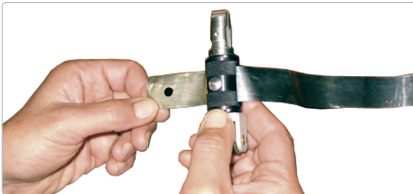
а) размагничивание, движение размагничивателя слева направо
