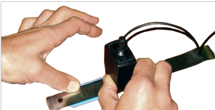
б) - магнитографирование, движение сканера слева направо
