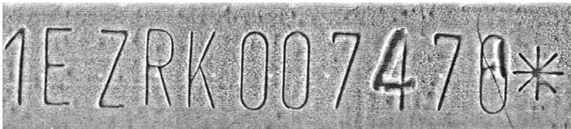
Илл.5. МОВ фрагмента номерной площадки кузова автомобиля с фрагментами первичных номеров (...1EZRK007470*), измененных методом заливки перемычек легкоплавким металлом (ЛКП не снималось).
